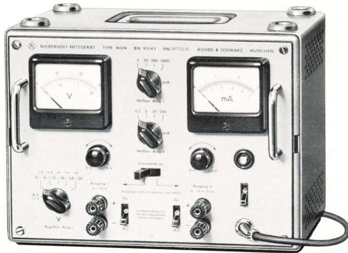
Zwei Gleichspannungen • elektrisch getrennt • unabhängig einstellbar •
